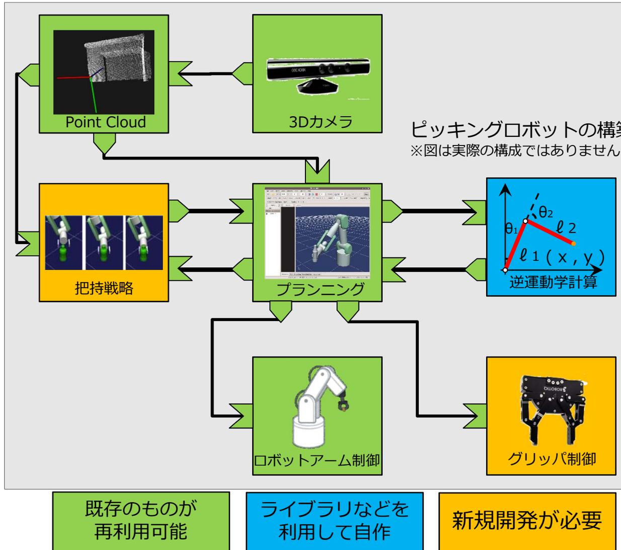
ピッキングロボットの構築例
