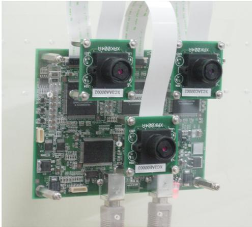
図 3 ステレオカメラ装置
