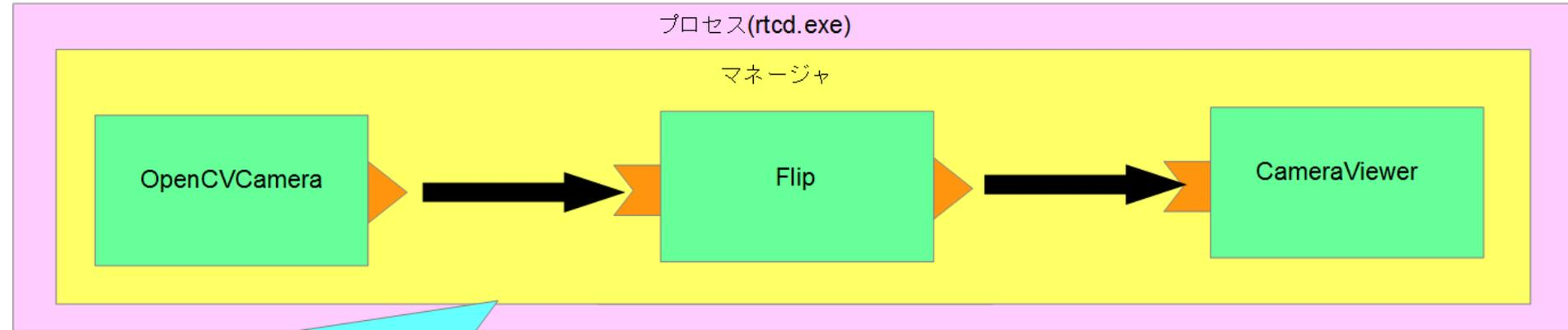
同一プロセスで起動した場合、CORBAの通信が関数呼び出しになるため通信が高速になる
