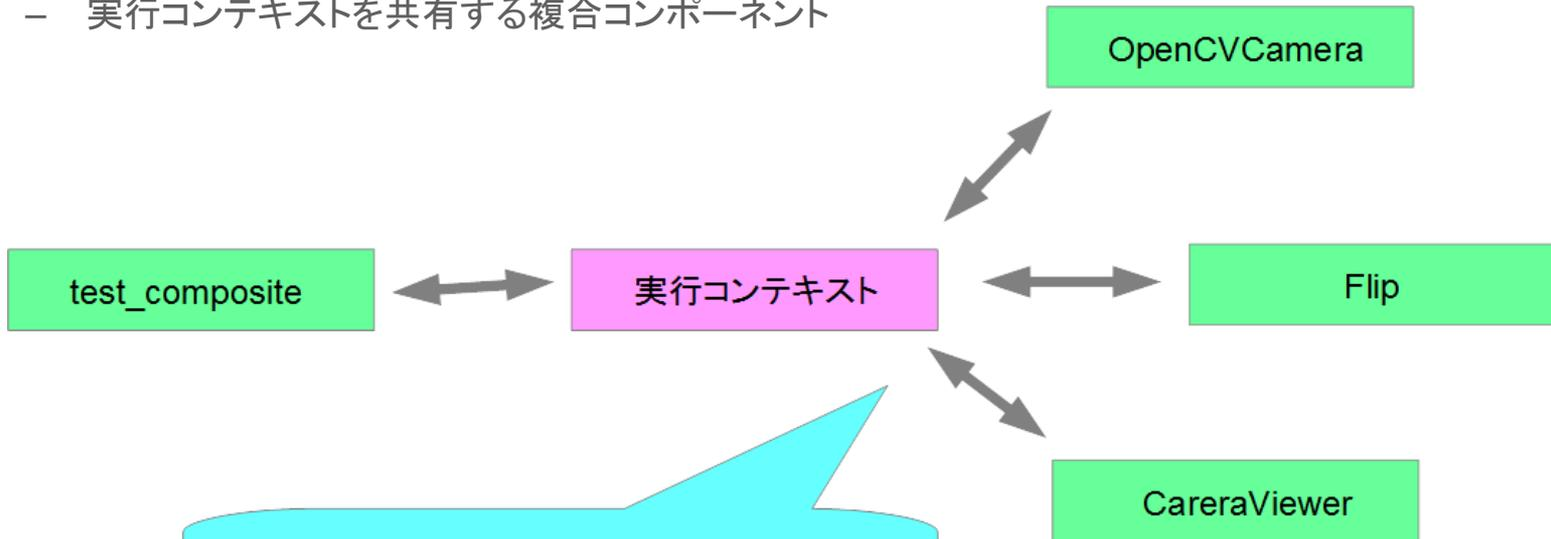
複合コンポーネントがCreated状態の時に生成した実行コンテキストに各コンポーネントを関連付ける
