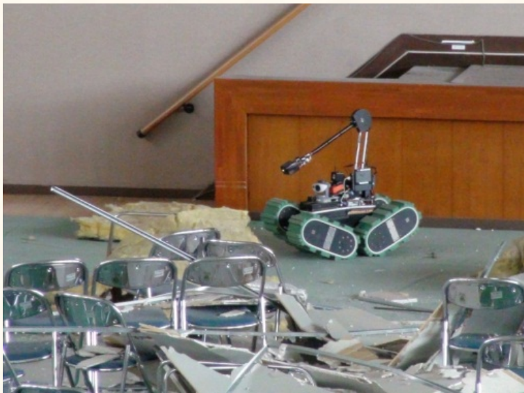
RTミドルウェア対応させた災害対応ロボット (上左下左: KOHGA3、上右: MATOI、下右: MATOIのRTM構成)
