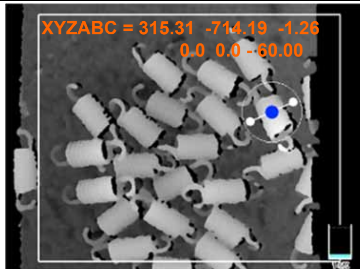
ばら積み部品の把持点認識処理例
